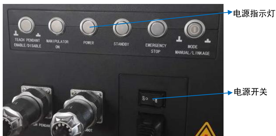
图 9-1 控制柜电源开关及指示灯示意图
