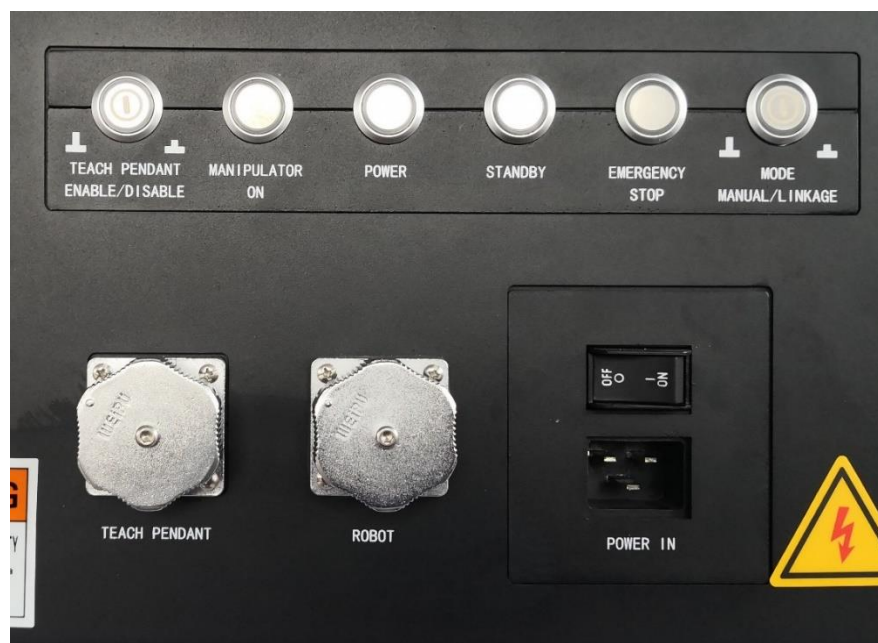
图 7-2 控制柜前面板示意图
