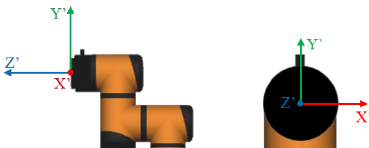
图 10-12 末端坐标系(flange_center)
