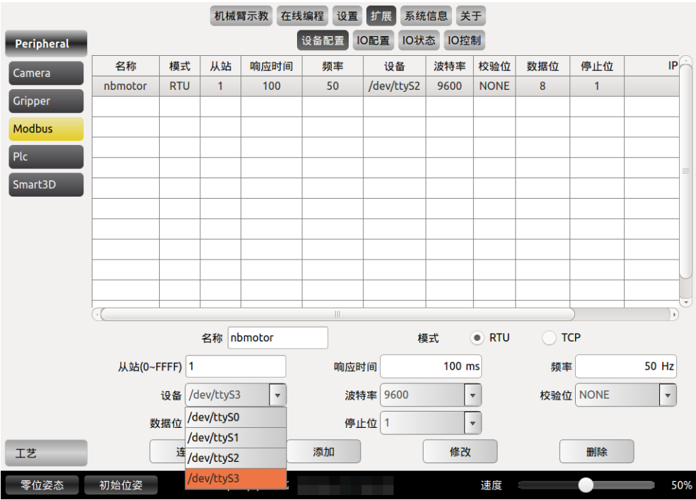
图 10-60 Modbus 设备配置
