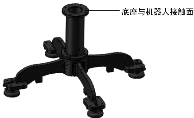
图 6-3 底座结构示意图
